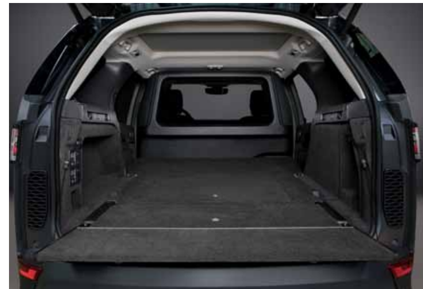
Afbeelding toont vlakke laadruimtevloer met uitneembare panelen (accessoire).
