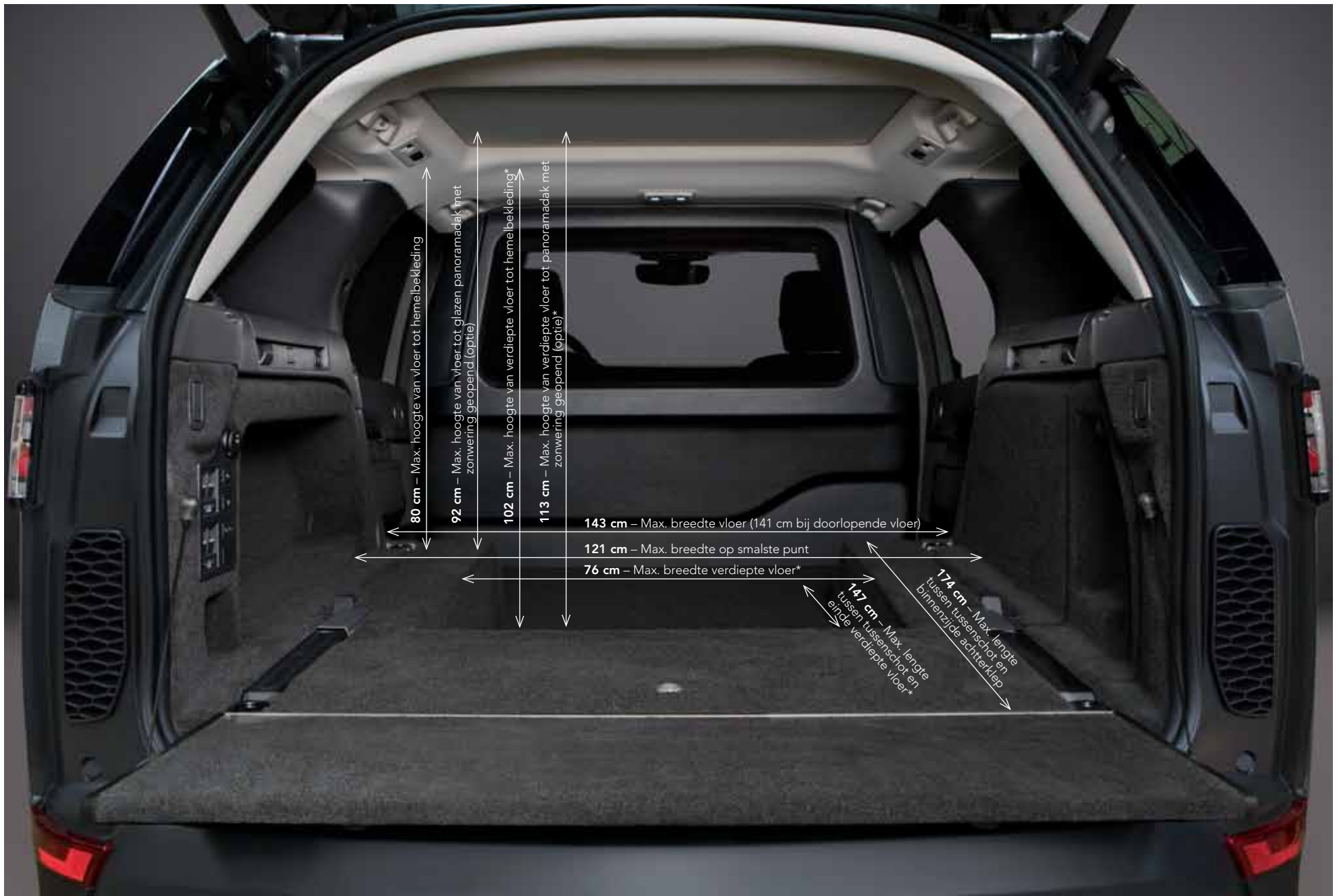
Afmetingen laadruimte - deze kunnen verschillen al naar gelang gekozen uitvoering en geselecteerde opties. * Ook van toepassing op auto's met vlakke laadruimtevloer (accessoire) - zie foto links. N.B.: de ervaring leert dat de getoonde afmetingen afhankelijk zijn van het gekozen meetpunt en dienen slechts ter indicatie van de beschikbare ruimte. Neem voor specifieke afmetingen contact op met een Land Rover dealer of controleer zelf de exacte afmetingen aan de hand van metingen.
